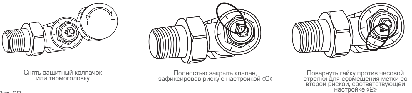
Рис. 20. Пример преднастройки клапана терморегулятора
