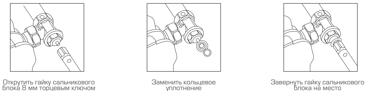
Рис. 21. Замена кольцевого уплотнения штока клапана терморегулятора
