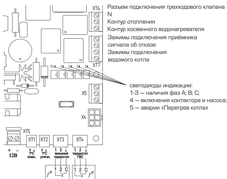
Рис. 5. Расположение разъемов на плате контроллера
