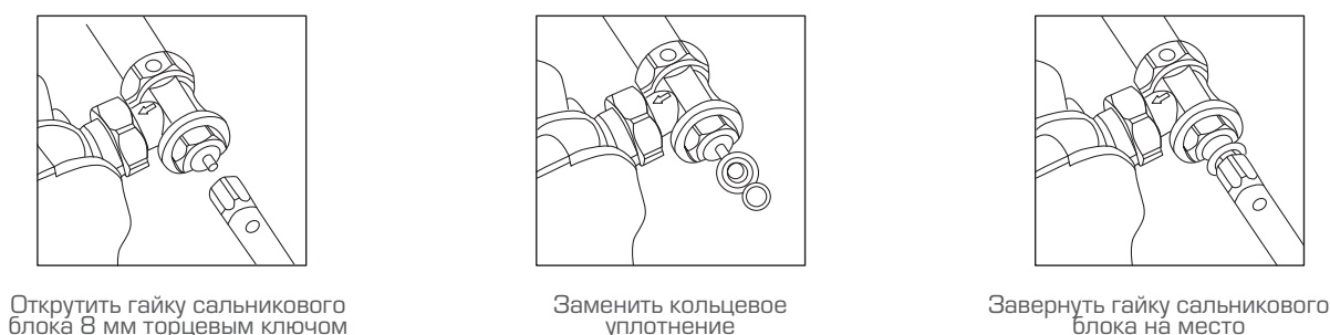
Рис. 21. Замена кольцевого уплотнения штока клапана терморегулятора
