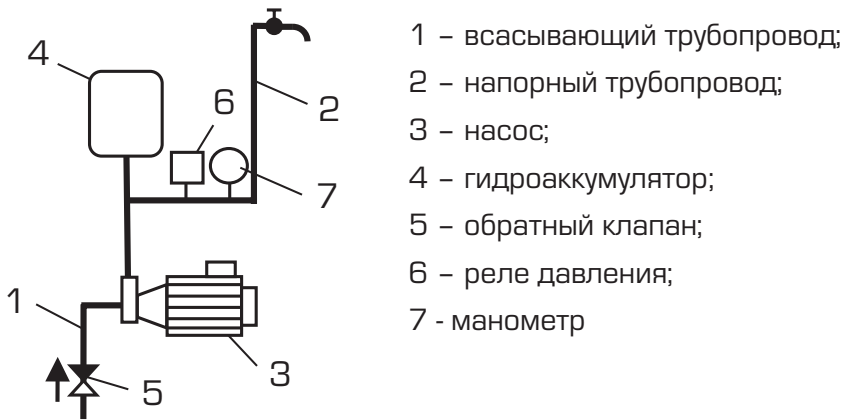
Рис. 18. Схема водоподъемной установки системы водоснабжения
