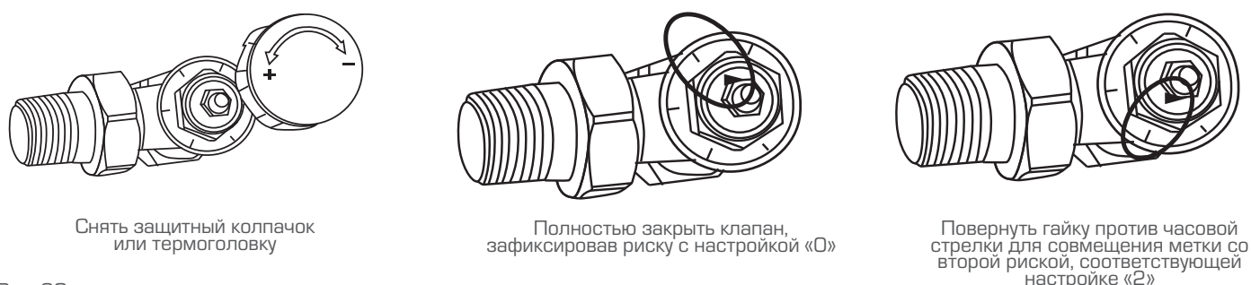
Рис. 20. Пример преднастройки клапана терморегулятора
