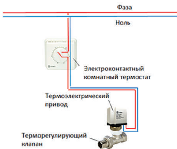
Рис. 3. Схема электрических соединений сети управления
