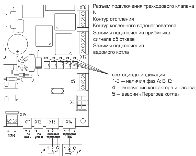
Рис. 5. Расположение разъемов на плате контроллера
