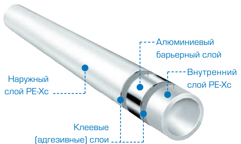
Рис. 2. Пятислойная труба РЕ-Хс/АІ/РЕ-Хс
